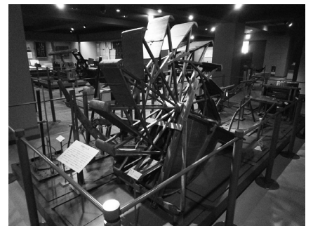
図2 踏車 奈良 明治27年 全長224.0cm 「郡山新町大阪屋栄治」銘。〈天理参考館蔵〉 羽15枚。水車部分の径148cm。
